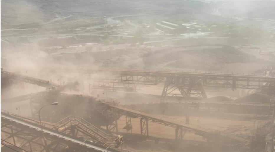
**Polvo fugitivo:** es el material particulado no controlado que escapa al ambiente desde una fuente generadora o del confinamiento poco eficiente o inexistente.
